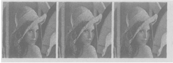
图 2 左边是加方差为 0.02 的 speckle 乘性噪声的 lena 图像, 中间是林石算子处理后的图像, 右边是本文中新算子处理的结果, 迭代次数 10 次, K = 10
